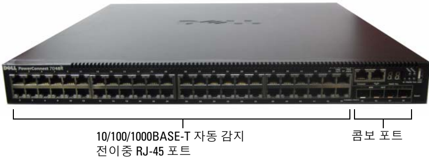
그림 1-6. 48개의 10/100/1000BASE-T 포트가 있는 PowerConnect 7048R
