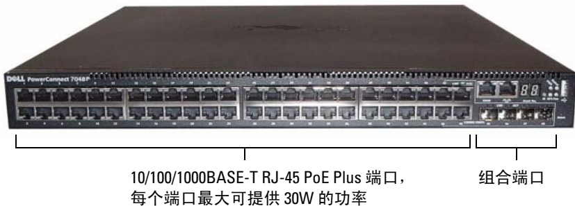
图 1-5. PowerConnect 7048P, 具有 48 个 10/100/1000BASE-T PoE Plus 端口
