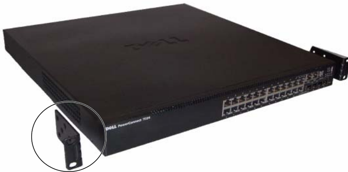
Ilustración 1-11. Fijación de los soportes
